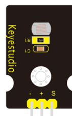
Ejemplo: Módulo sensor de luz LDR
