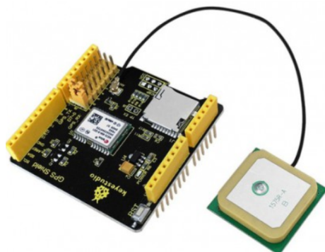
Shield GPS (comunicación serie)
