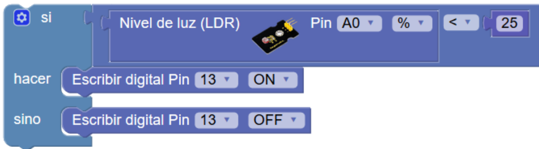
Ejemplo: Encendido de un led cuando el nivel de luz es inferior al 25%
