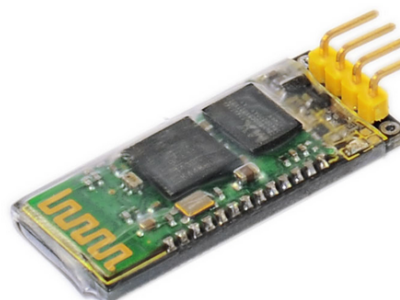
Módulo Bluetooth HC-06 (comunicación serie)
